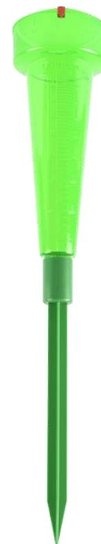
Pluviomètre 40 mm d'eau au m<sup>2</sup> à lecture directe afin de mesurer les précipitations et d'en faire le cumul
