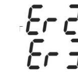
‘Er 2’ se muestra cuando el termómetro se expone a un cambio rápido de temperatura ambiente.
