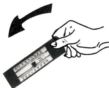
Si les index devaient glisser dans le liquide clair, ramenez-les dans le liquide orange avec l'aide d'un aimant (par exemple avec la bande aimantée) en appuyant sur le bouton central.
